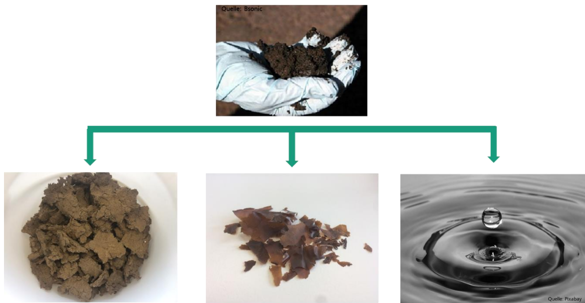
Abbildung 1: Separation des Klärschlammes in Faser-, Gel- und Flüssigkeitsfraktion - AQUATTRO GmbH
